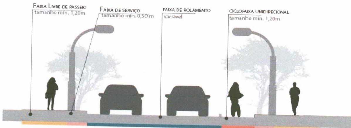
Figura 5-26. Corte viário esquemático de ciclofaixa unidirecional. Fonte: Elaborado por Certare.
