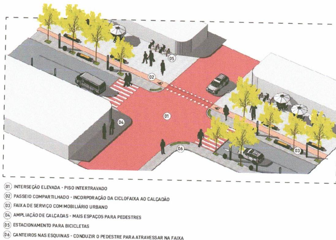
Figura 5-37. Proposta de intervenções para as interseções que são portais de entrada para a zona 30. Fonte: elaborado por Certare.
