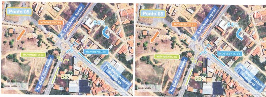
Figura 2-9: Detalhamento dos movimentos estudados no ponto 05.
